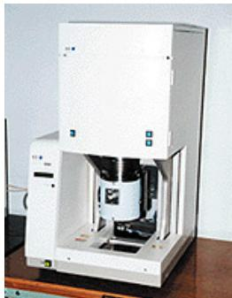
動的粘弾性についてこのページで少々御説明いたします。動的粘弾性試験とは、試験片に振動を与える試験方法です。これによって、例えば、DSCやTMAなどの熱分析では測定されないTgも測定可能です。
