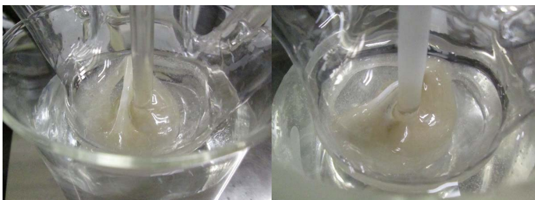
図 12 ODA 系ポリアミド酸の重合溶液の様子（反応の進行により粘度が大きく上昇）
