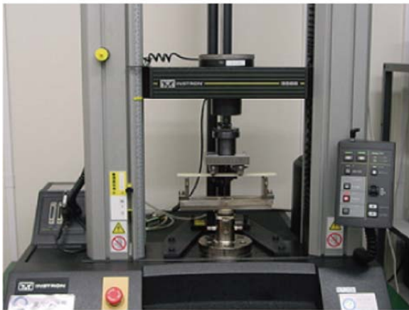
四点曲げ試験（試験機全体）
