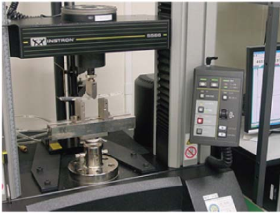
三点曲げ試験（試験機全体）
