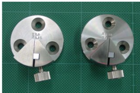
図2 クランプ(左：R2.0mm，右：R0.38mm)
