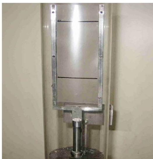
燃焼円筒の試験片支持具部分
