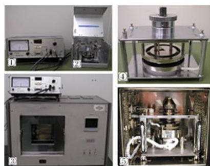
絶縁体の抵抗測定装置
