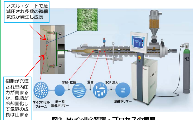
図2 MuCell®装置・プロセスの概要
