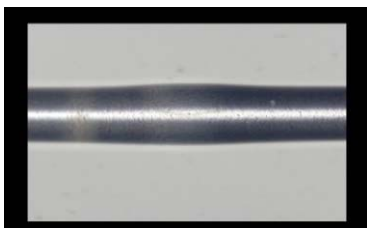
図4 PP(伸長粘度が低い樹脂のストランド延伸時) 図5 LDPE(伸長粘度が高い樹脂のストランド延伸時)
