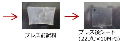
図5 プレポリマー法によるTPU調製プロセス
