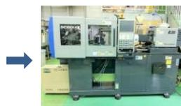
射出成形による試験片作製
