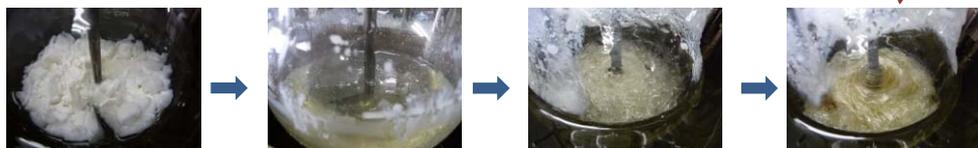
BHTを窒素下で溶解 → 加熱融解後に減圧開始 → 脱グリコール反応 → 重縮合が進行し高粘度化
