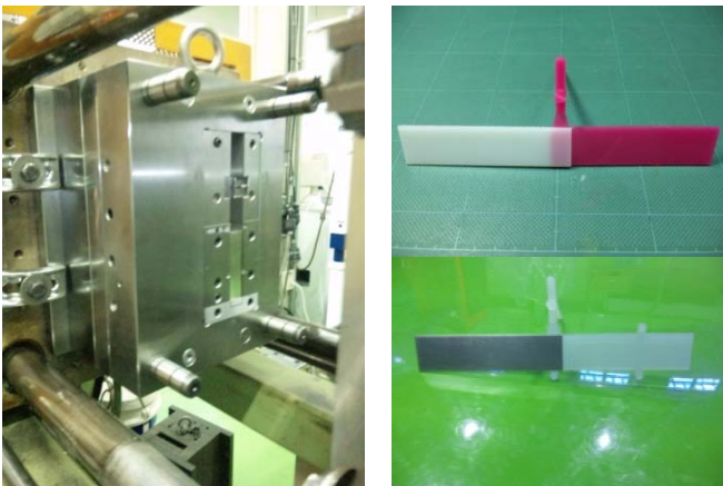
Fig. 接着強度評価用金型と接着剤レス成形品 (上：PP-PP 下：アルミ-PP)
