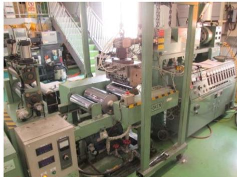
①300幅テスト機(試作用) φ30単軸押出機-単層仕様
