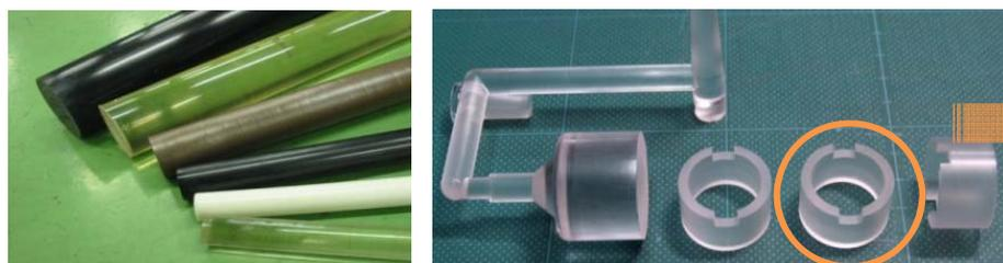
Fig. 押出成形からの切出し(左)、射出成形品からの切出し(右)
