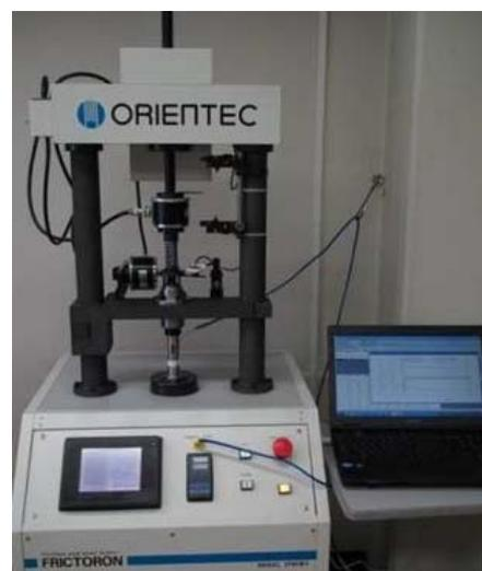
Fig. 摩擦摩耗試験機
