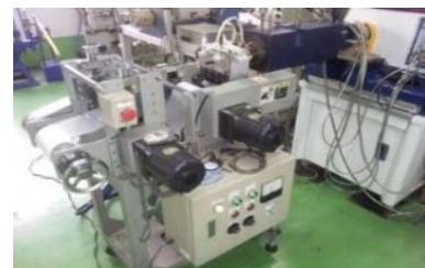
原反フィルム作製用単軸押出機 (φ20) (東洋精機製ラボプラストミル)
