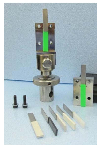
ISO 19095 引張せん断ジグと試験片の写真
