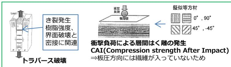
樹脂の強靱化・層間接着力の向上が鍵 ⇒ インターレイヤー(PA, PESパウダー分散)ステッチング法(面外方向)
