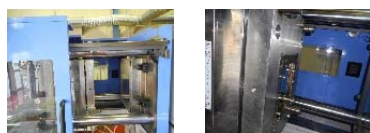
● コアバック金型：形状：□150mm平板、初期厚さ：1.5mm コアバック可動距離：最大8.5mm(コアバック後厚さは最大10mm)
