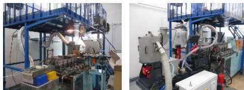
小型二軸押出機 (左:水冷ストランドカット, 右:UWC)
