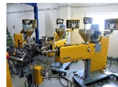
350幅多層機(横浜)
