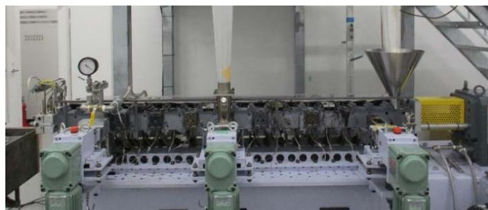
◆有効L/Dや投入位置、バレル温度の細かい調節により、より多種の材料に対応可能
