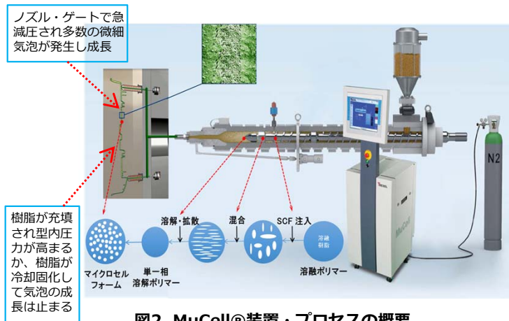
図2 MuCell®装置・プロセスの概要
